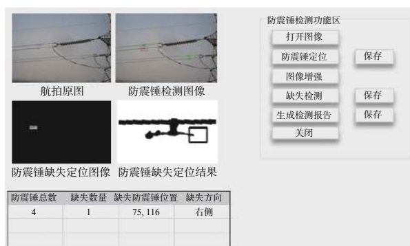
图 13 防震锤缺失检测软件界面
